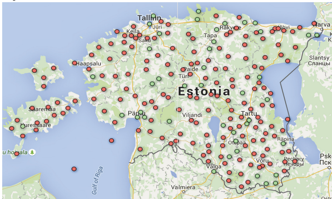
Joonis 4.9. >300 kW Eesti katelseadmed 2012. aasta seisuga (punane: maagaasil katelseadmed; roheline: puitkütustel katelseadmed; sinine: muu tahkekütus (v.a puit); kollane: gaaskütustel katlamajad (v.a maagaas); lilla: vedelkütustel katlamajad) 159
